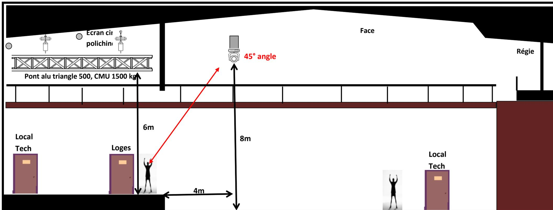
Profondeur scène : 8m20, mur à mur : 18m, hauteur maxi sous grill : 6m, 4 moteurs 500kg + 4 stop-chute : CMU 1500kg réparti
